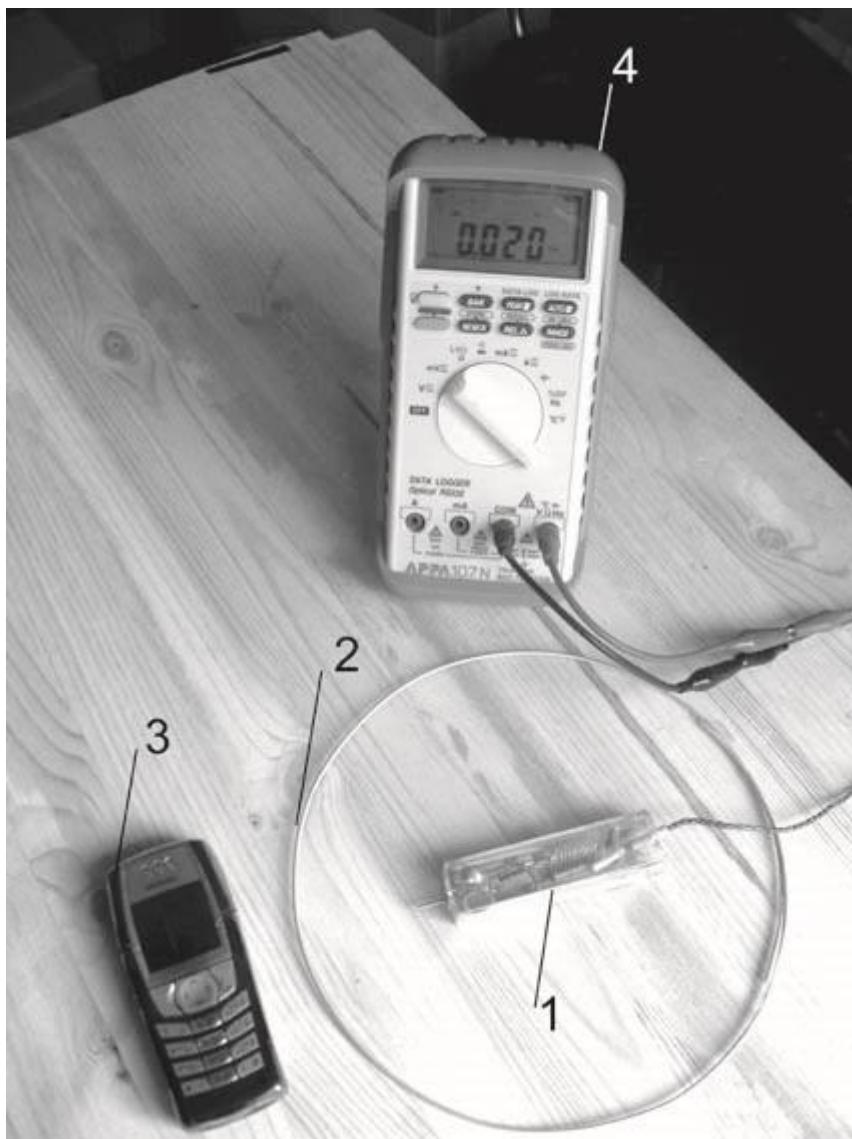
Далее я проделал аналогичные измерения с таким же кольцом, но предварительно покрыл его слоем серебра. Напряженность в центре кольца упала до 0,007 мВ – уже
